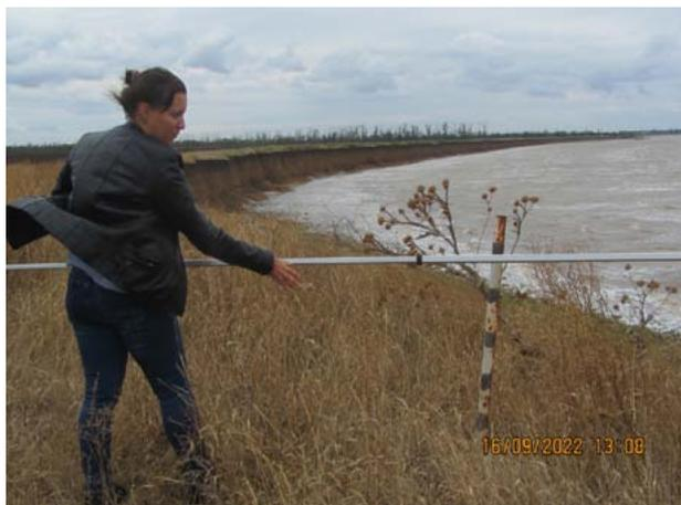
*Рисунок 1.4.2.2. Г. Приморско-Ахтарск. Створ № 33. Замер расстояния от репера до кромки берегового склона*
